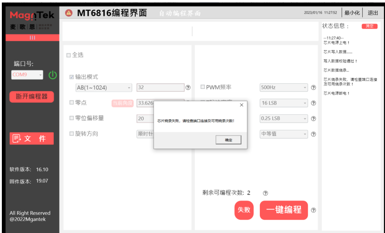
图 4.2.9 烧写失败显示界面
